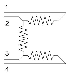
FOR 3PH OPERATION L1-1 & 4, L2-2, L3-3 FOR 1PH OPERATION L1-1 & 3, L2(N)-2 & 4
